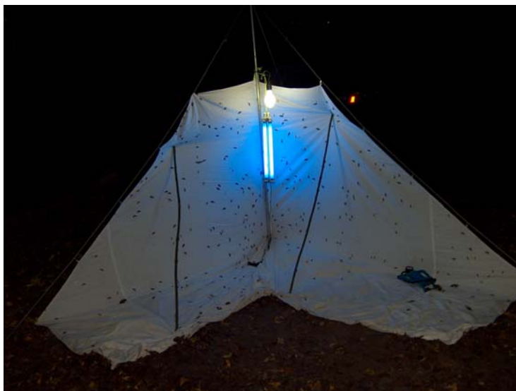
Abb.1.: Leuchtanlage mit Quecksilberdampflampe und superaktinischen Röhren
