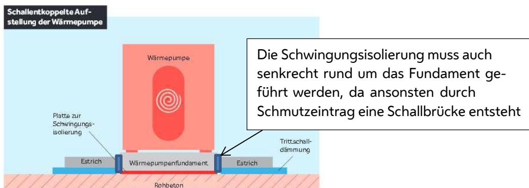
Abb. 26 Körperschall entkoppelte Aufstellung der Wärmepumpe Quelle: AIT 2013
